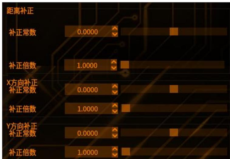
【补正常数】对修正倍数修正后的值进行+/-修正，可输入正负数
