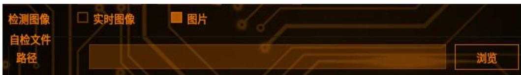
【图片】显示“自检文件”组，供客户选择图片文件夹路径，并读取其中的文件。自检时根据图片后方的 OK、NG 标识对检测进行对比，结果一致则输出 OK，不一致则输出 NG
