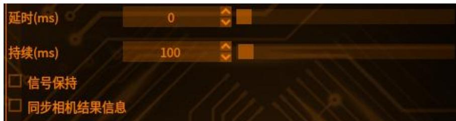
【运行信号/准备信号】当软件进入运行界面后，会通过指定端口输出完成信号，输出信号的电平与设置的输出电平保持一致
