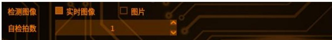
【实时图像】显示“自检拍数”数字选填项，隐藏“自检文件”。现有流程不变，当进入自检时，UI显示自检模式，所有流程正常运行。如果物料使用网络触发或 I/O 触发需要接受到触发指令才可以进行自检
