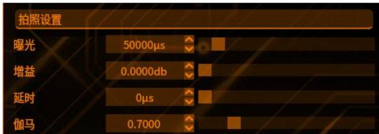
【曝光】时间越长画面越亮，反之则画面越暗曝光时间的单位为微秒（us）。在有高频振动的机台，延长曝光时间可能导致图像模糊，此种情况下可以选择调整相机增益
