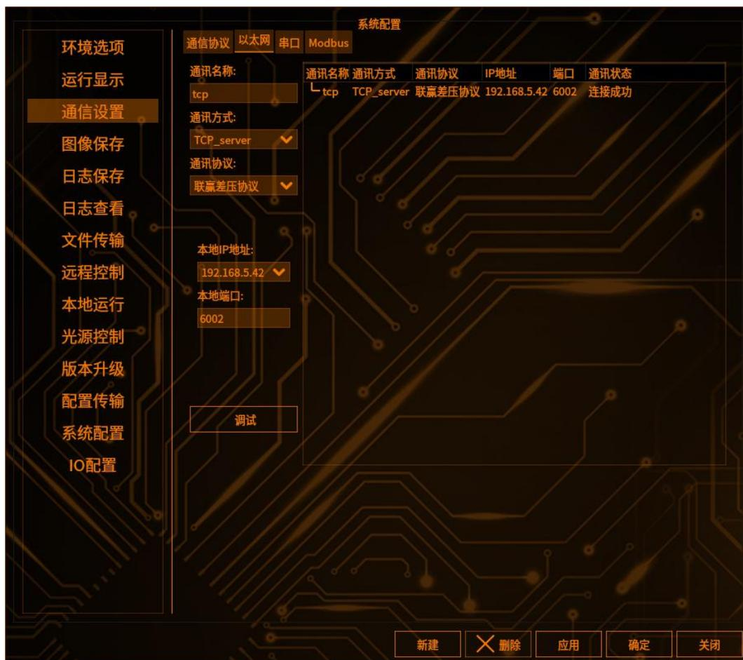
客户端：输入 IP 和端口点击连接，输入 CCD 拍照的指令，点击写配置，发送拍照指令，即可收到 CCDxx 拍照结果 OK/NG，以及输出的检测值
