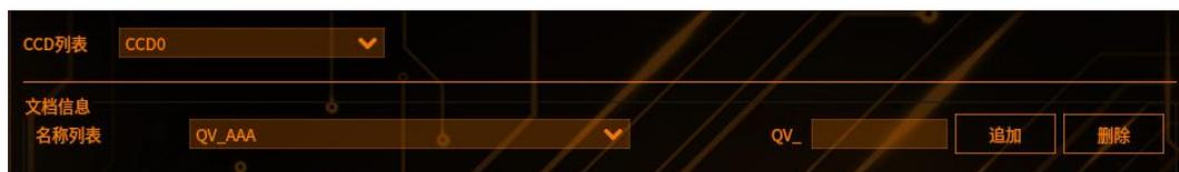
CCD 列表：根据“运行显示”勾选的工具来执行对应 CCD 分类，通过切换不同 CCD 来更新对应 CCD 下的名称列表和工具列表
