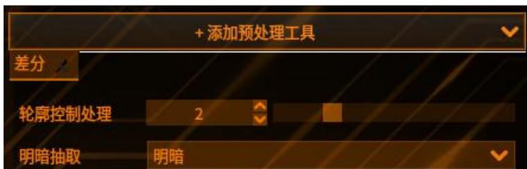
【轮廓控制处理】排除检测对象轮廓附近的干扰，数值越大，控制效果越好，但同时也会降低对细微变化的敏感度
