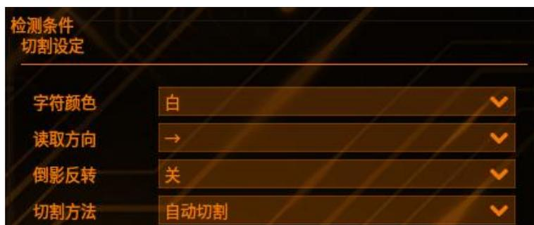
(1) 字符颜色 (黑/白)：可设置检测字符的颜色，由于算法只接受黑白图像，故在图像导入算法前会自动将彩色图片转换成黑白图片。若自动转换的图片切割或识别效果不理想，可考虑利用预处理工具手动调整
