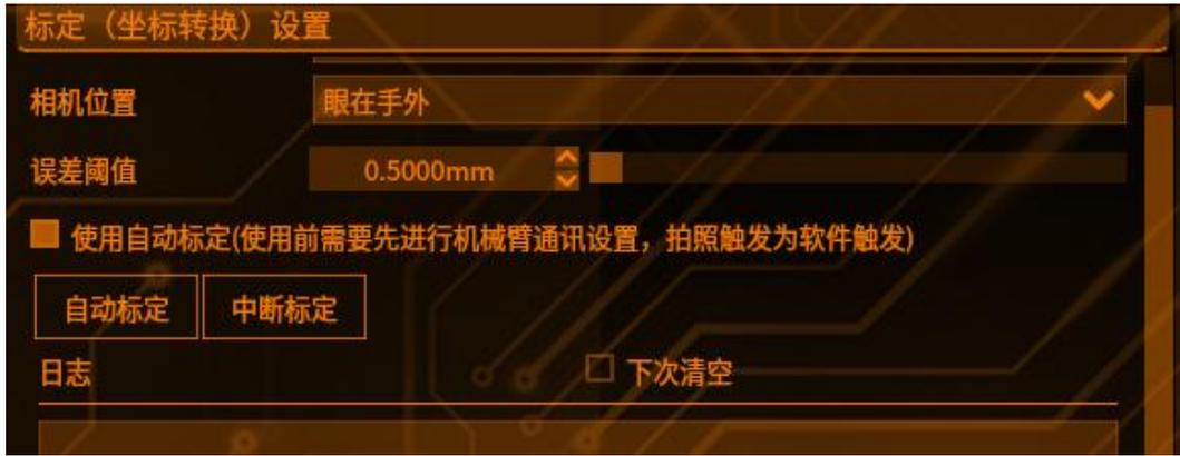
进行自动标定时须在标定设置中勾选使用自动标定，开启自动标定，然后进行 PLC 交互。
