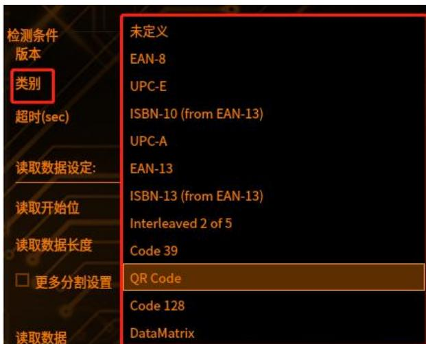
如果选择未定义，可以自动识别所匹配到的码类型，DataMatrix 和 ISBN-13 码类型除外
