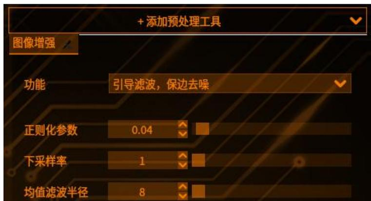
【正则化参数】用于控制平滑程度和包边效果，当设置趋近于 0 时接近原图
