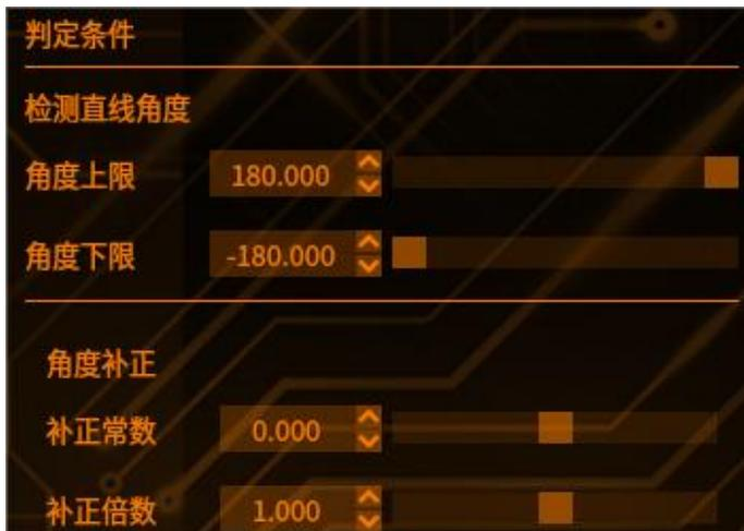
【检测直线角度】： 两点生成直线的角度
