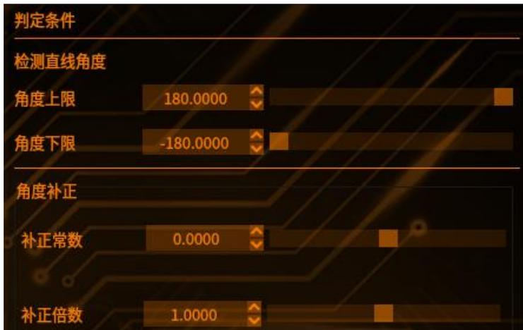
【检测直线角度】：两点生成直线的角度
