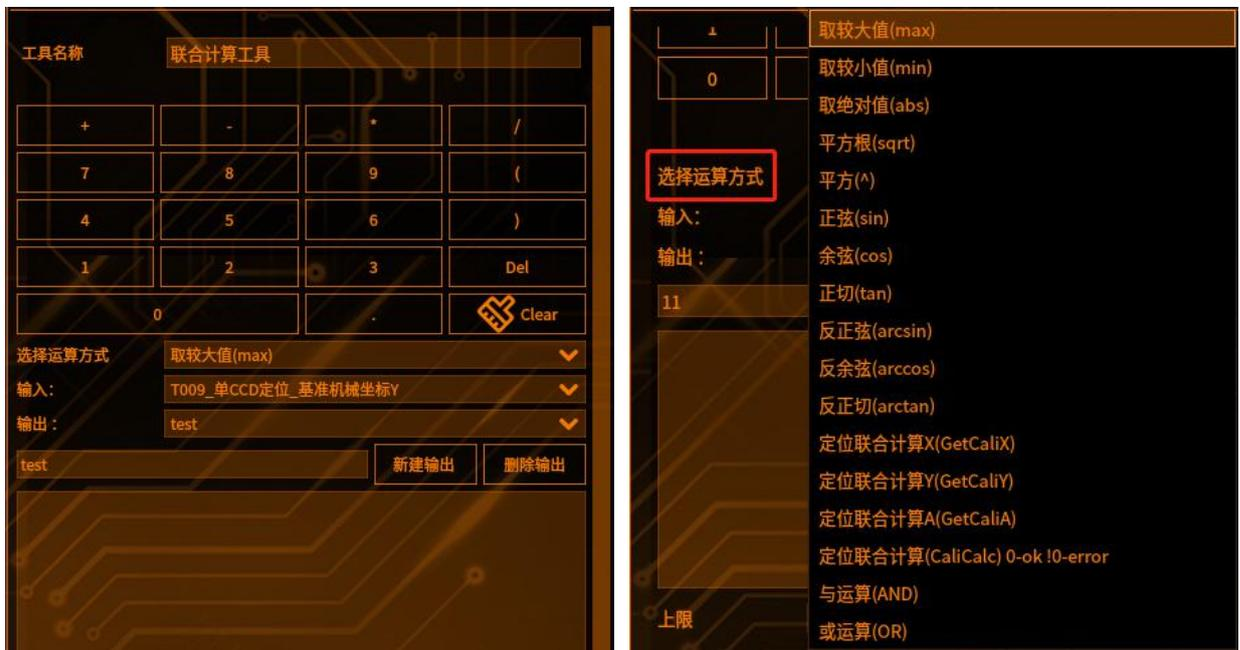
**最大值(max):** 可以筛选出一组计算对象中的最大值，运算方式为： $\max(\text{计算对象}, \text{计算对象}, \text{计算对象})$
