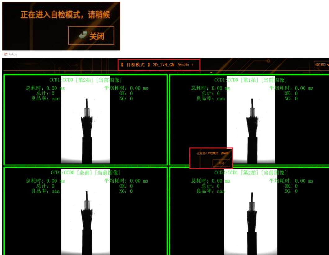
显示的图像为自检图像，物料号右侧显示“自检模式和自检次数”图像上的绿色框代表检测前和自检时对比的结果（如：检测前是 NG，自检时也是 NG，则对比结果显示绿色框，反之，结果两者不对应时显示红色框）
