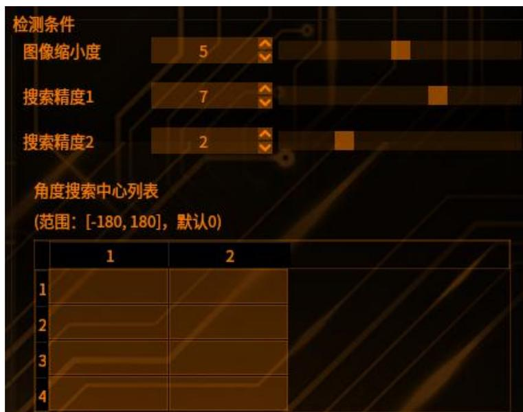
【图像缩小度】缩小度越高，搜索速度提高，精度下降；反之搜索速度下降，精度提高
