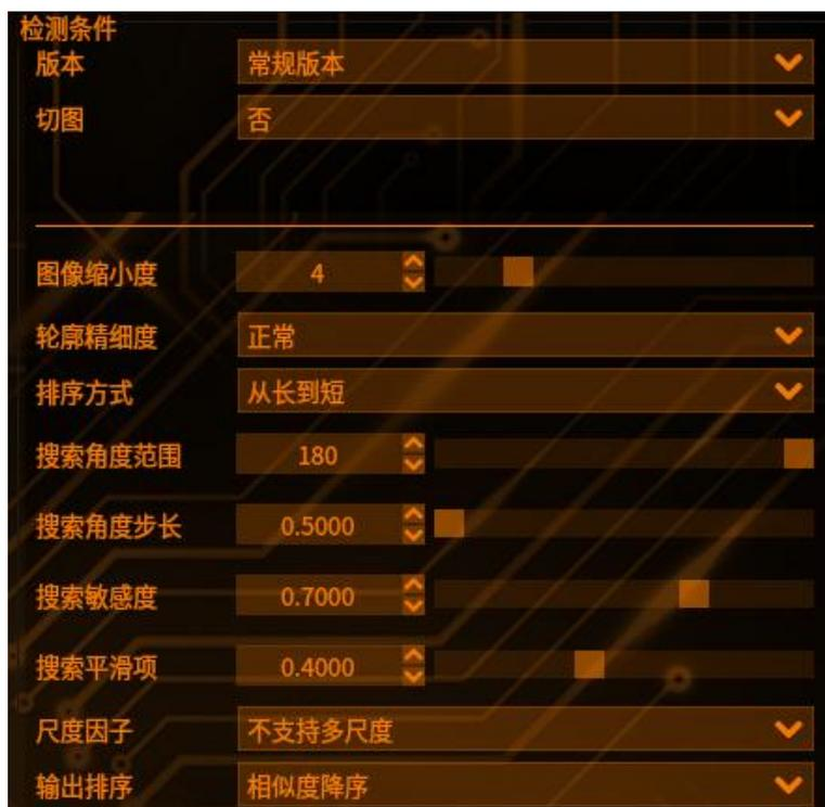
【切图】选择切两份和切四份。选择切图时，请进行绑核设置。切图仅对矩形搜索框有效。
