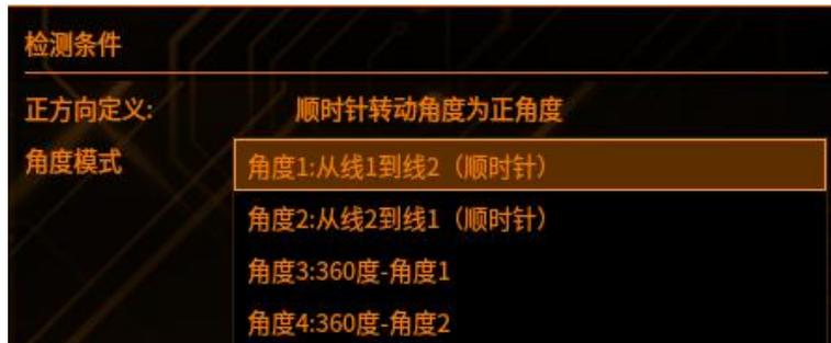
【角度 1】检测顺时针方向线 1 到线 2 之间的夹角
