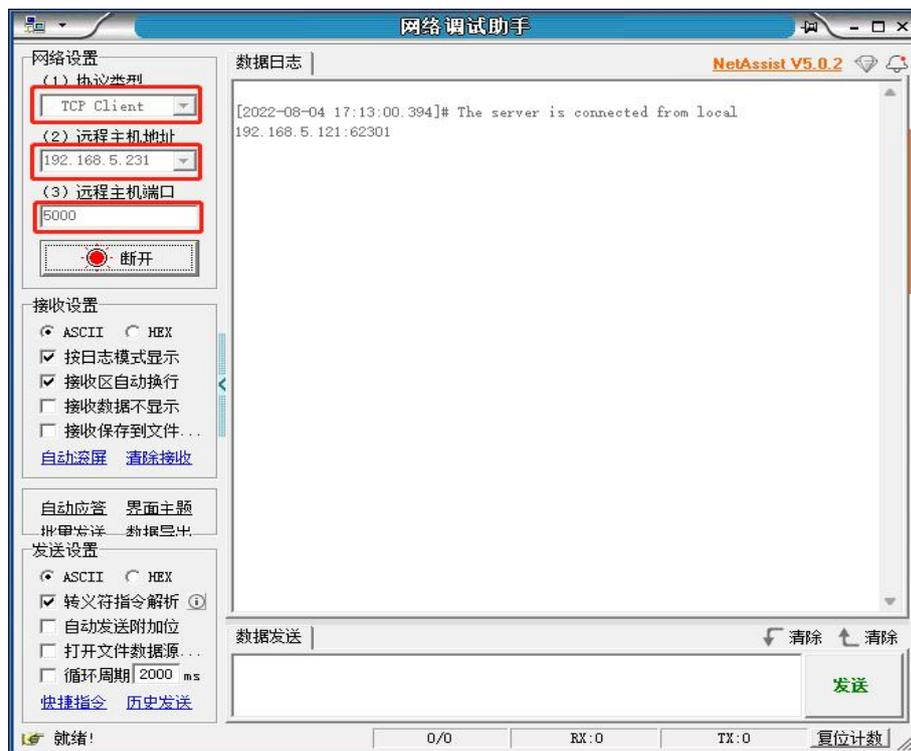
客户端：输入 IP 和端口点击连接，输入 CCD 拍照的指令，点击发送，发送拍照指令，即可触发拍照
